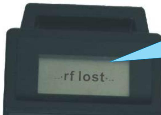
当无线MPG和USB接收器连接不成功（比如USB接收器没有插上电脑），则无线MPG的LCD会如下显示：
