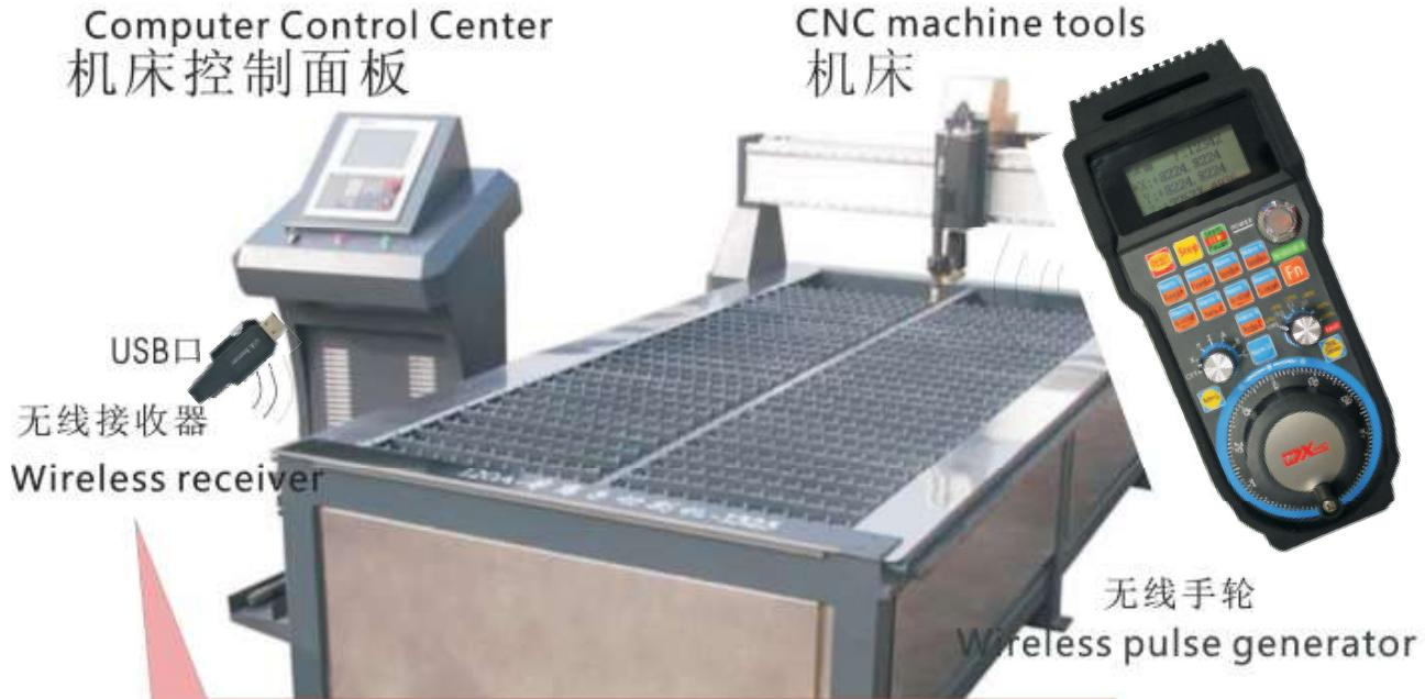
注意：为了信号的稳定，请将接收器安装在机箱外面（不能安装在机箱内部）
